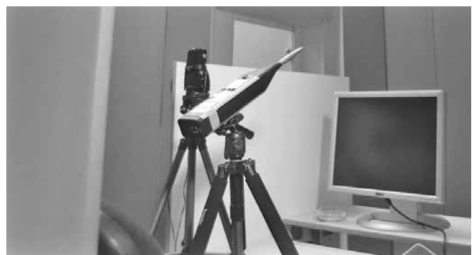
Abbildung 3: 15 Messung der Lautstärke durch Anderson Acoustics Berlin
