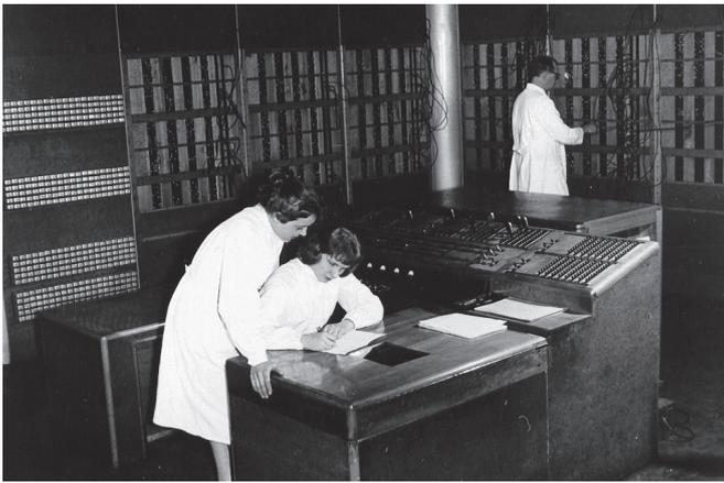
Bild 8: Arbeit am Kommandopult der OPREMA; im Hintergrund wird ein Programm gesteckt. Die Stecktafelprogrammierung macht deutlich, dass das von-Neumann-Prinzip noch nicht realisiert wurde.
