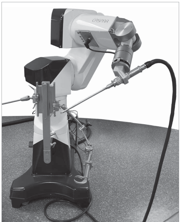
Operationsroboter CASPAR, Ausstellungsexemplar im Museum der Firma Maquet
