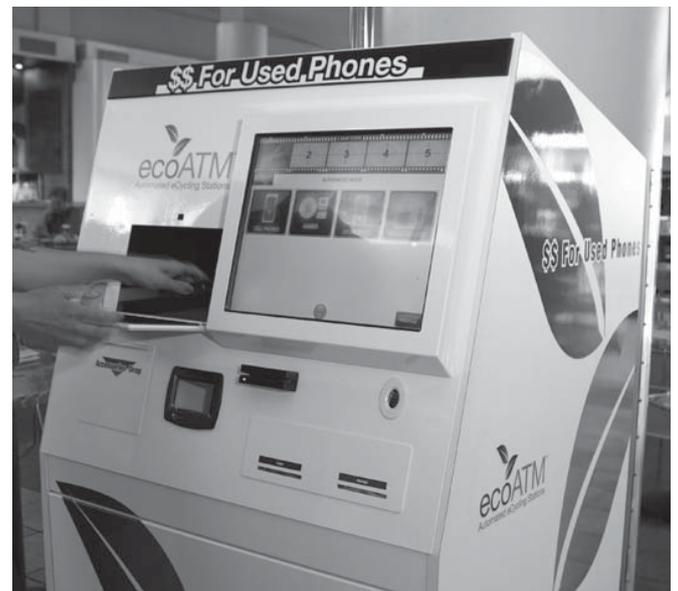
*In den U.S.A., wo es kein national geregeltes Rücknahmesystem gibt und WEEE-Richtlinie, RoHS oder Basel keine Rolle spielen, entstehen private, stationäre Rücknahmesysteme: Das Handy wird in die Klappe gelegt, das Gerät scannt das Modell automatisch, behält es ein und druckt einen Gutschein aus oder spendet für einen guten Zweck. © 2011 ecoATM ([www.ecoatm.com](http://www.ecoatm.com))*
