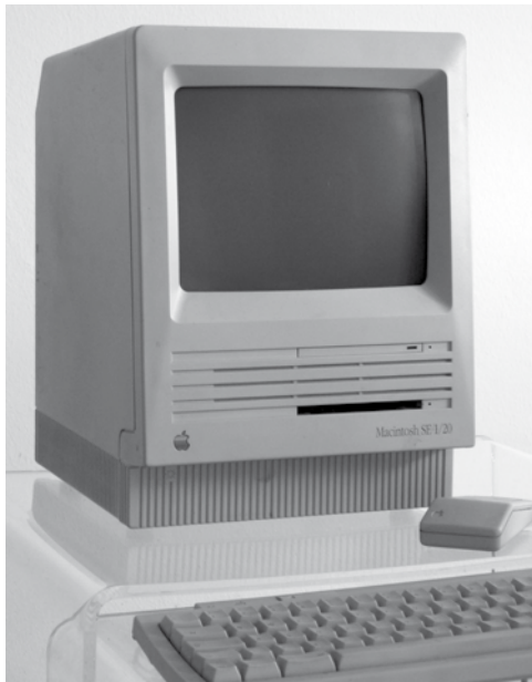
Mac SE 1/20 (1987), Nachfolger des legendären Mac 128k, mit 1MB-Arbeitsspeicher und 20MB-Festplatte
