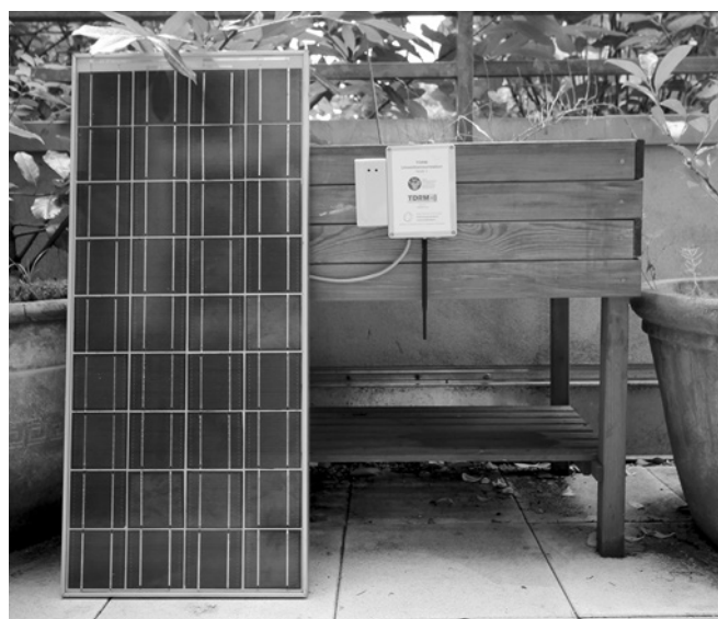
Erster Prototyp der FIF-Umweltsensorstation
