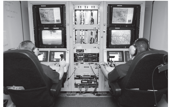
Boden-Kontrollstation für Drohnen-Einsätze Foto: Gerald Nino, CBP, U.S. Dept. of Homeland Security
